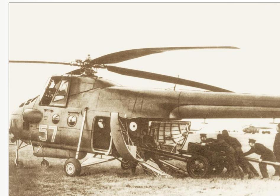
**Погрузка пушки в грузовую кабину вертолета Ми-4В**
