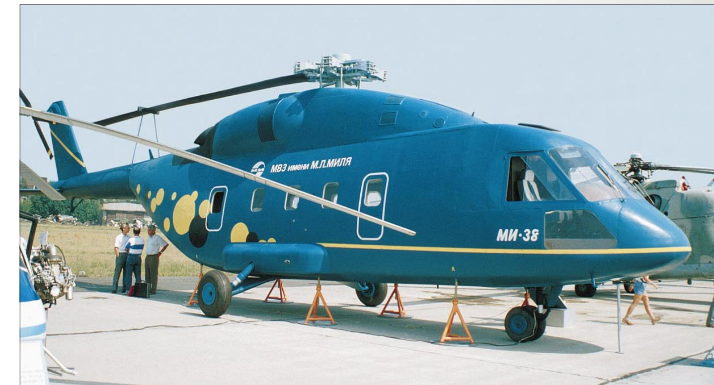
Конструктивно фюзеляж делится на три части: носовую, среднюю и хвостовую. В носовой части, обладающей отличным обзором и эргономикой, размещаются два рабочих места пилотов.
