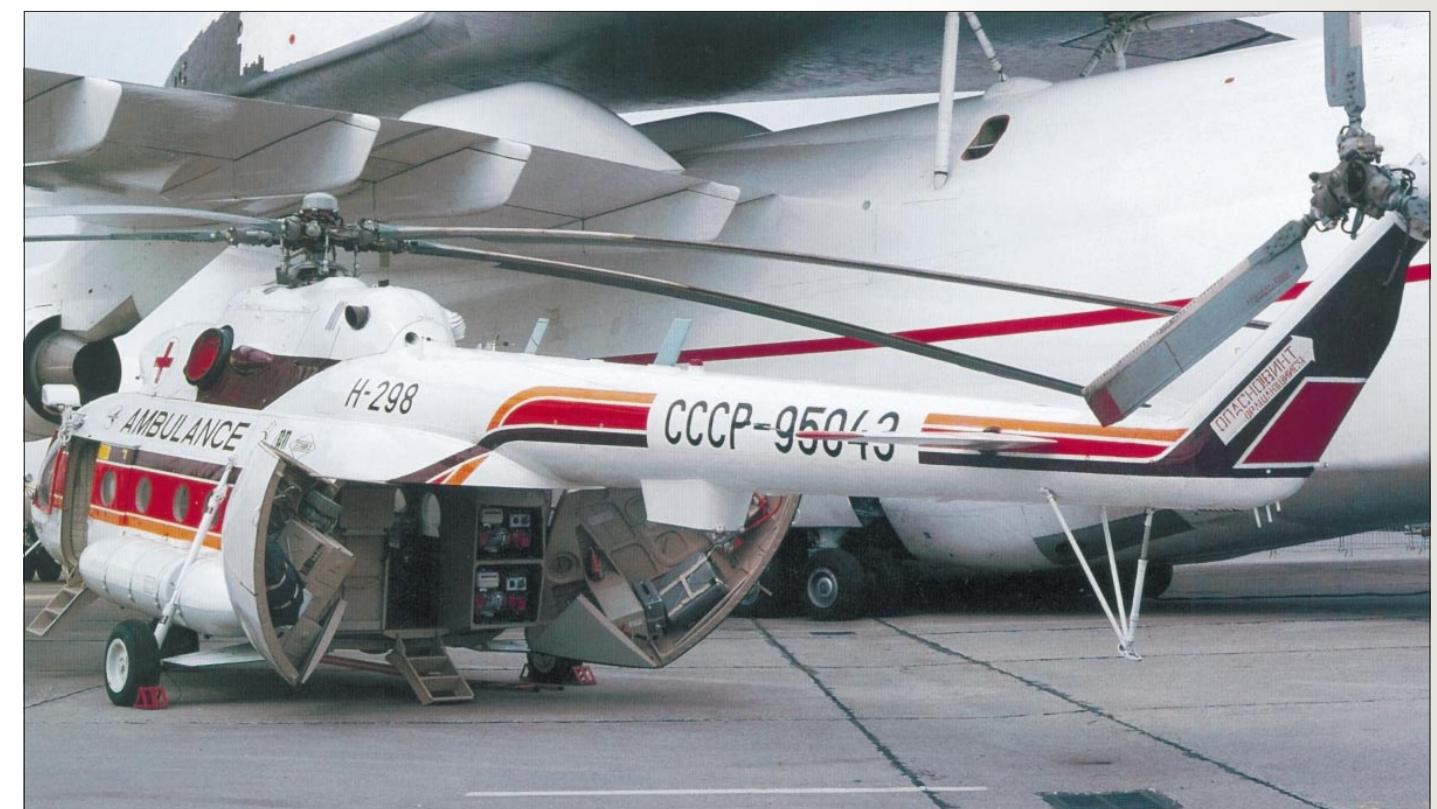
**Модернизированный вариант вертолета-госпиталя. В задних створках грузового отсека расположены компактные генераторы для электроснабжения «операционной»**
