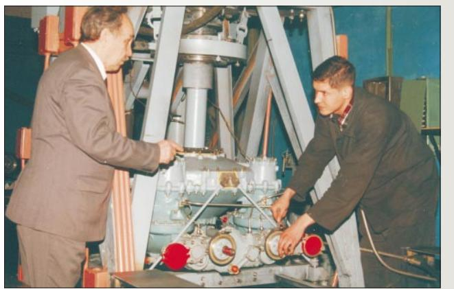
**Участок динамических испытаний агрегатов несущей системы вертолета «Ансат». Уникальный стенд для динамических испытаний агрегатов трансмиссии**
