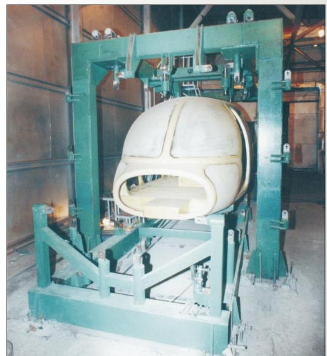
**Носовая часть кабины «Ансат», изготовленная из композиционных материалов**
