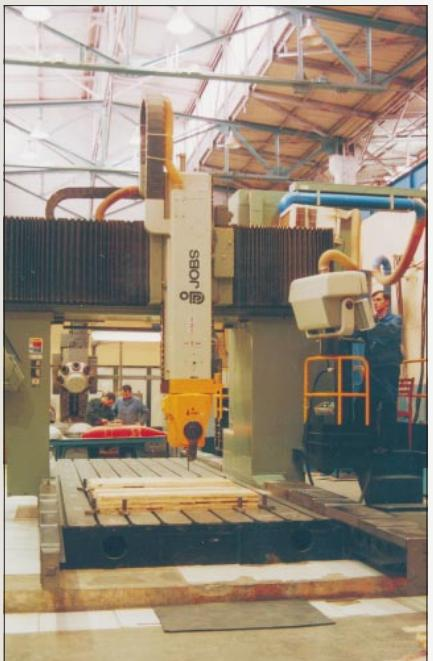
**Пятикоординатный станок фирмы JOBS для изготовления крупногабаритных моделей, пресс-форм, шаблонов, штампов**
