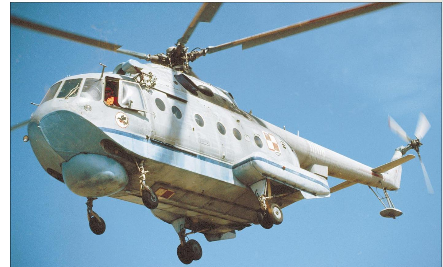
Главной «изюминкой» Ми-14 стала нижняя часть фюзеляжа, выполненная в виде лодки, которая изготавливается из сотовых панелей. Применение сотовых панелей позволяло обеспечить надежную герметичность корпуса, плавучесть, получить объемы для размещения топлива и вооружения.
