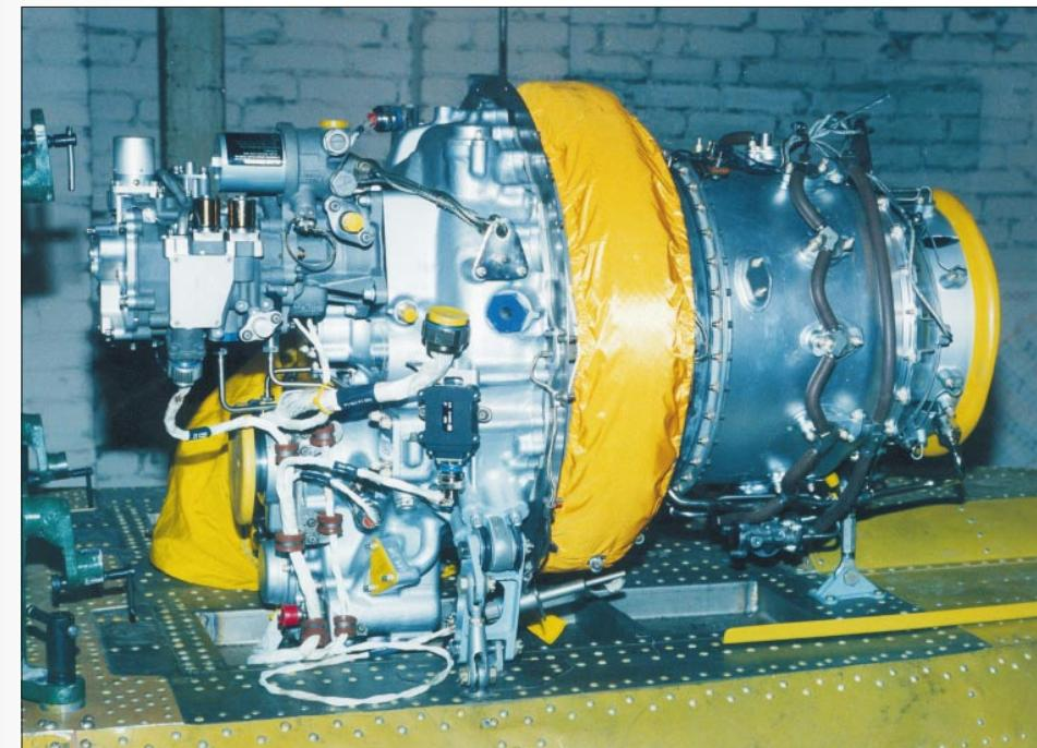
**Двигатель фирмы Pratt & Whitney PW-206, установленный на втором прототипе вертолета «Ансат»**
