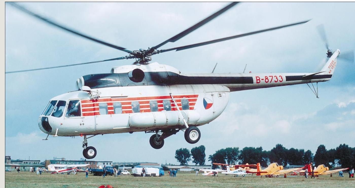
Первоначально проект выглядел так: предполагалось целиком использовать несущую систему вертолета Ми-4 с четырехлопастным несущим и трехлопастным рулевым винтами, новый фюзеляж должен был максимально сохранить обводы и конструкцию своего предшественника, а двигатель испытывался на Ми-6. В таком виде проект обещал быть весьма малозатратным, а реальные результаты – быстрыми.
