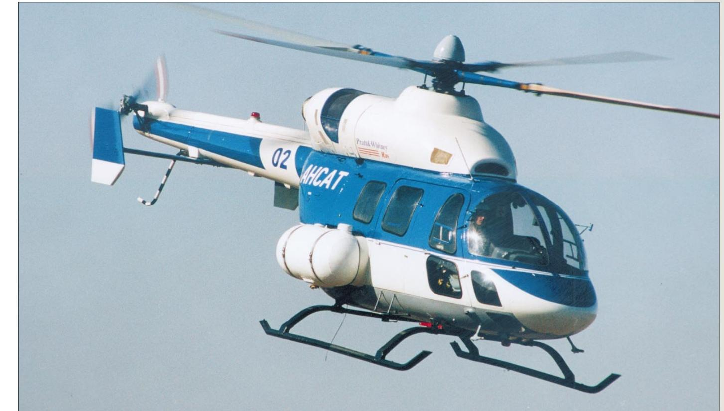
ка-выгрузка производится через две широкие боковые двери. В задней части фюзеляжа может быть установлена дополнительная дверь-люк для загрузки багажа. Хвостовая балка цельнометаллической клепаной конструкции, в ней установлен хвостовой редуктор, на ней – стабилизатор. Вал трансмиссии проходит над хвостовой балкой и закрыт кожухом. К хвостовой балке крепится хвостовая опора, предохраняющая рулевой винт от касания земли. Шасси полозкового типа.
