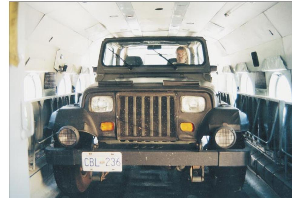
**Размеры грузопассажирской кабины вертолета Ми-8 позволяют перевозить крупногабаритные грузы**
