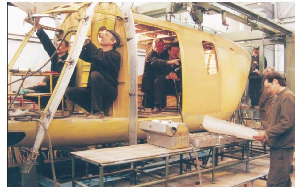
**Стапельная сборка третьего прототипа вертолета «Ансат»**
