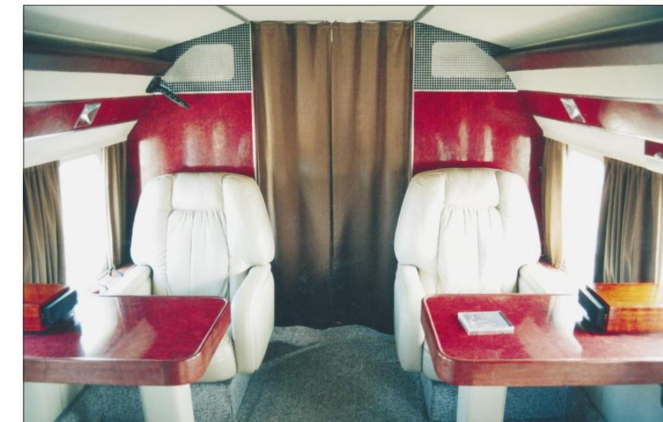
ветствовать требованиям российских и международных стандартов. Обычно для отделки салонов используют натуральную и искусственную кожу, пластик, ковровые покрытия, частично натуральное дерево. Для создания легкой и функциональной корпусной мебели (перегородки, шкафы, буфеты, столешницы, багажные полки) широко используются трехслойные панели с сотовым заполнителем, все компоненты которого сертифицированы и строго соответствуют требованиям, предъявляемым к авиационным материалам по горючести.
