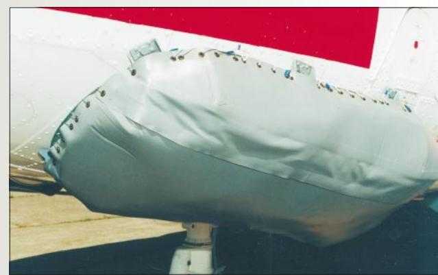
**Размещение системы аварийной посадки на воду на вертолете Ми-8МТВ**
