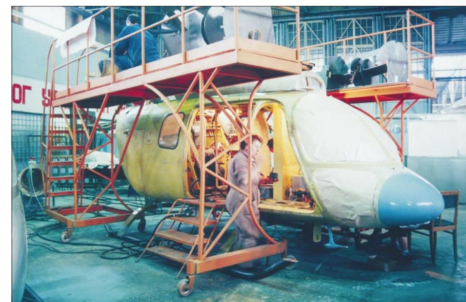
**Стапельная сборка второго прототипа «Ансата»**
