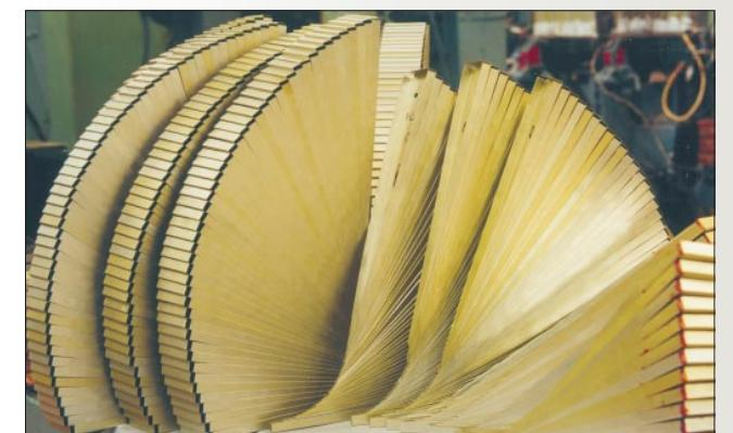
**Нервюры хвостовых отсеков лопасти**
