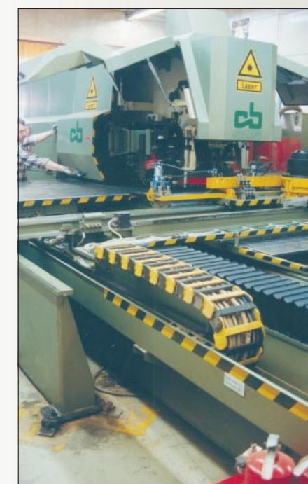
**Станок для комплексной обработки (лазерной резки) шаблонов**
