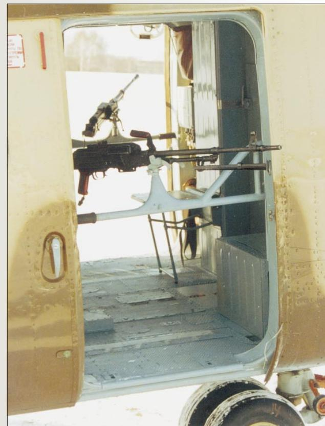
**На вертолете Ми-8МТВ-5 можно установить пулеметы в проемах левой и правой дверей. Рампа-аппарат позволяет перевозить крупногабаритные длинномерные грузы, которые не умещаются в кабине вертолета**
