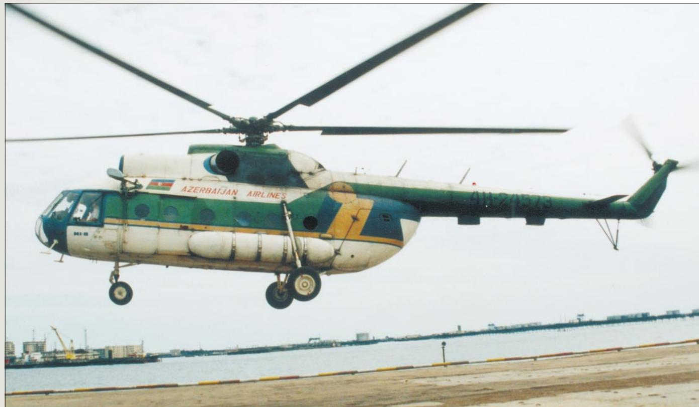
Одним из внешних отличий Ми-8П стали увеличенные топливные баки, поскольку топлива транспортных машин вследствие увеличения дальности полета не хватало для перевозки пассажиров.
