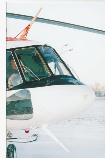
**Ножи для резки линий электропередач, установленные на вертолет Ми-172 южнокорейской полиции**
