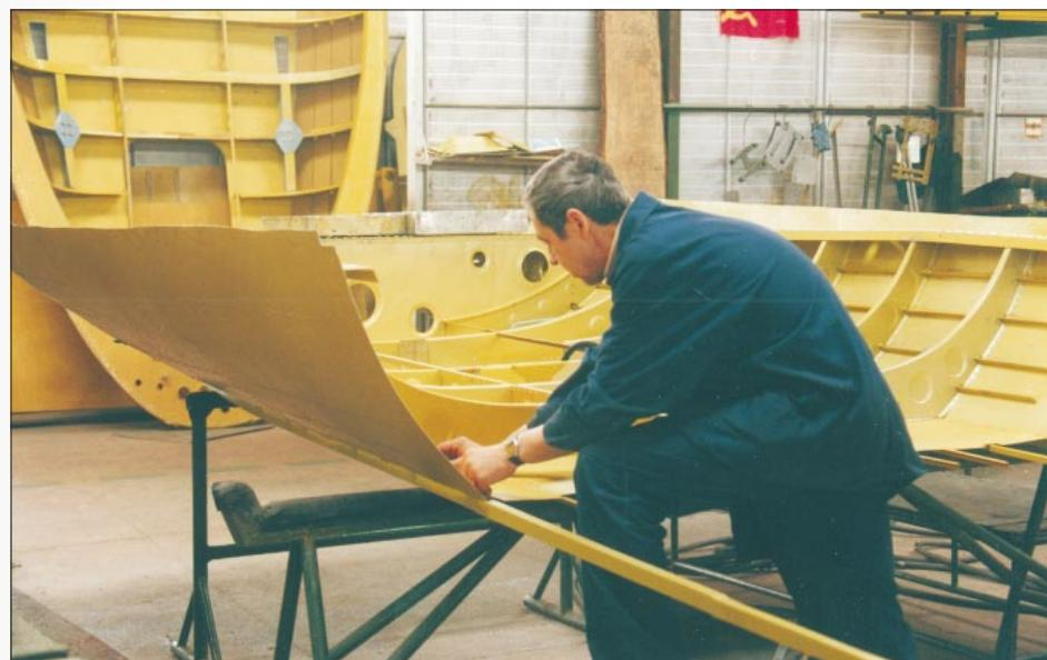
**Участок агрегатной сборки панелей фюзеляжа**
