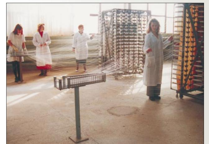
**Участок подготовки композиционных материалов для производства лопастей по технологии намотки**
