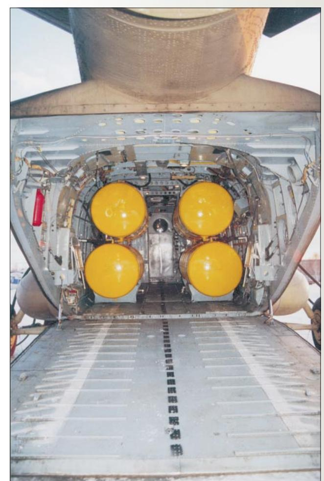
**Ми-8МТВ-5. Внутри грузовой кабины размещены дополнительные топливные баки, позволяющие увеличить до 2000 км дальность полета при перегонке вертолета**
