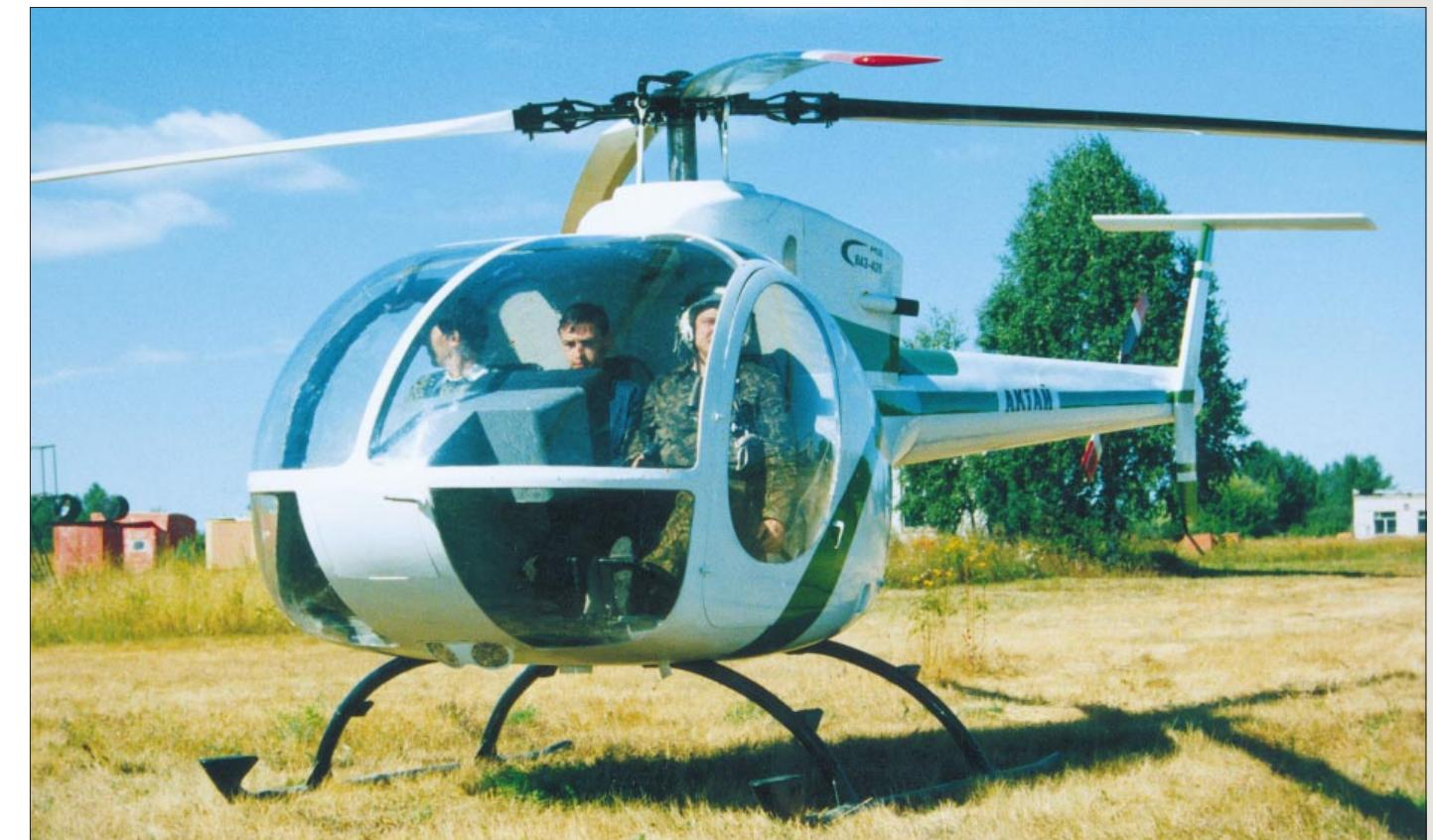
Несущая система вертолета «Актай» состоит из трехлопастного несущего винта диаметром около 10 м со стеклопластиковыми лопастями. Крепление лопастей к втулке бесшарнирное. Рулевой винт – двухлопастной, диаметром около 1,5 м.
