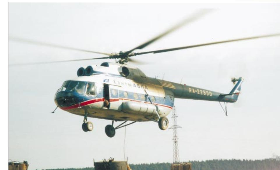
новых ГТД для вертолетов. Наиболее перспективным обещал стать ГТД конструкторского бюро под руководством С.П. Изотова. Этот двигатель и выбрали для замены АИ-24В. Пара ТВ2-117 (так обозначили новый двигатель) заменила один АИ-24В. В мае 1960 г. было принято решение о постройке вертолета В-8 в двухдвигательном варианте В-8А с двигателем ТВ2-117.
