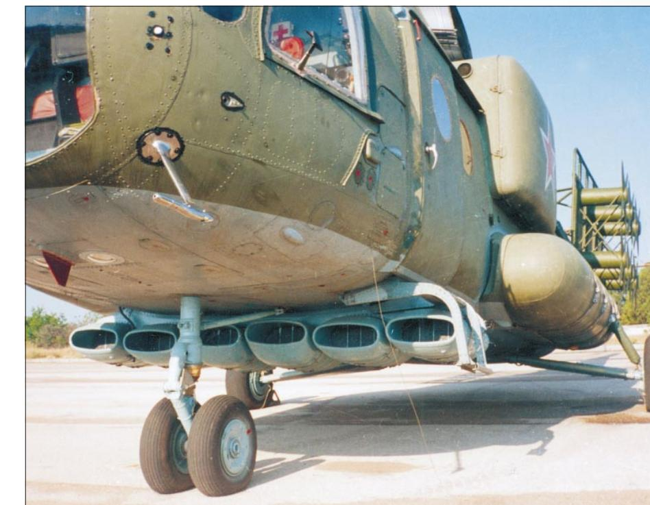
**На базе Ми-8 создано более 100 различных модификаций. На снимках: Ми-8ПП, предназначенный для постановки помех наземным РЛС обнаружения, наведения и целеуказания**
