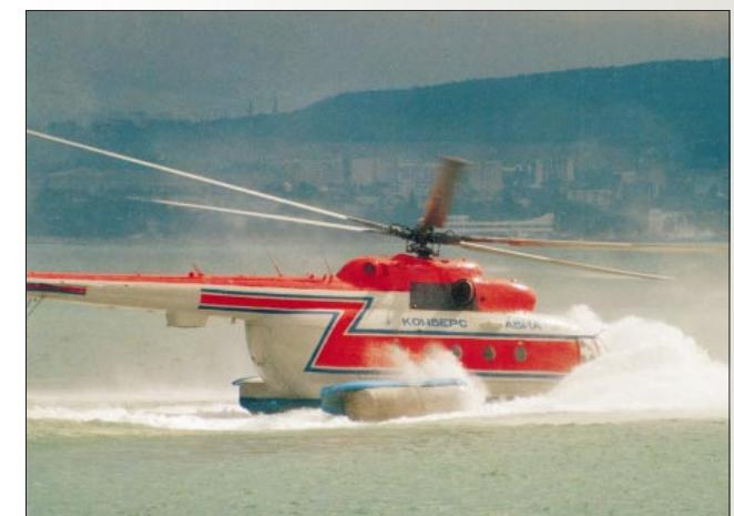
**Ми-14ГП авиакомпании «Конверсавиа». Грузопассажирская модификация для эксплуатации на морских нефтедразработках**
