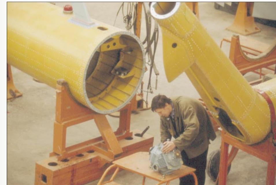
**Сборка хвостовой балки**
