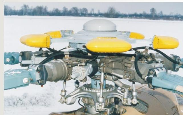
**Втулка несущего винта, оборудованная вибогасителем маятникового типа, обеспечивает более комфортные условия полета**
