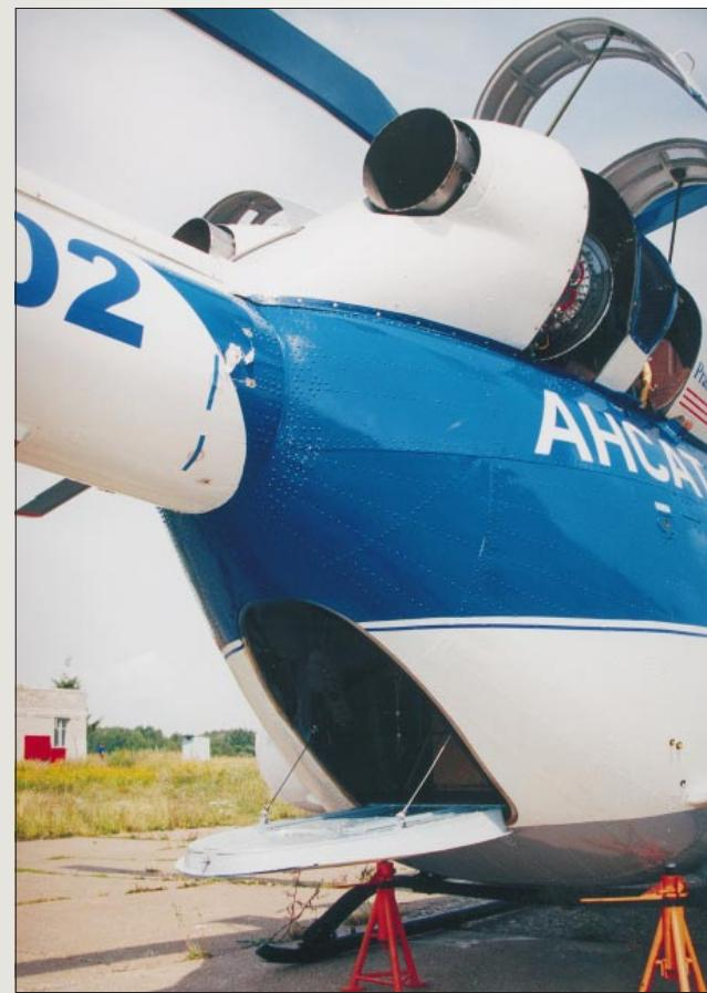
**Грузовой люк для погрузки-выгрузки багажа и больших на носилках в задней части фюзеляжа вертолета «Ансат»**
