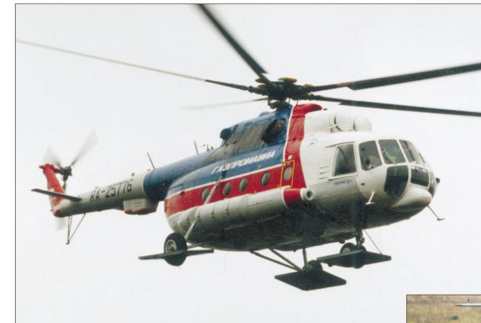
**Ми-8МТВ-1 авиакомпании «Газпромавиа» с дополнительными посадочными устройствами**
