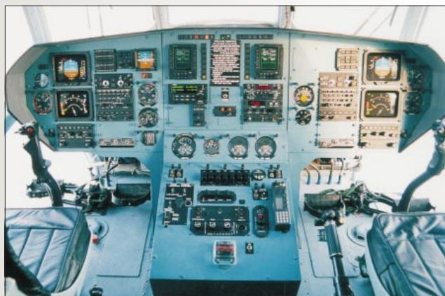
**Вариант приборной панели с оборудованием фирмы Honeywell**
