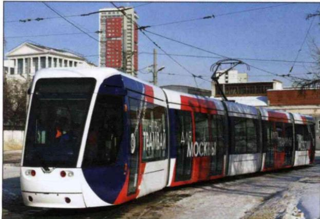
1. Шестиосный пятисекционный шарниро-сочленённый полностью низкопольный вагон CITADIS-302 с двухсторонним управлением производства «Альстом» (Франция).
