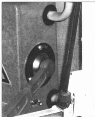
Рис. 30. Рубильник аккумуляторной батареи и тумблер задней двери вагона 71-619А.
