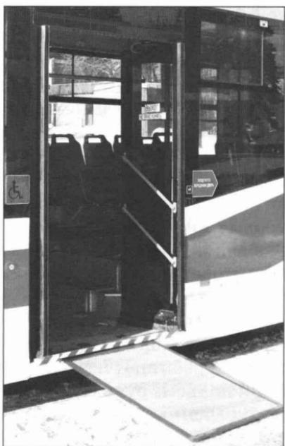
Рис. 69. Выдвижная аппаратель вагона 71-153.
