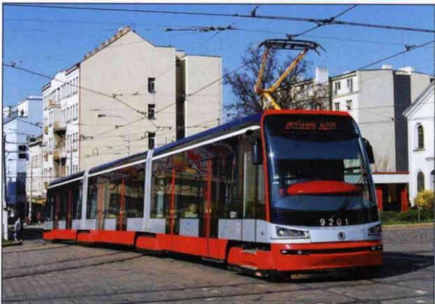
2. Трёхсекционный шарниро-сочленённый полностью низкопольный вагон 15T на четырех 4-колесных безосных тележках производства «Шкода» (Чехия).
