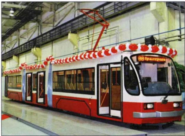
4. Четырёхосный трёхсекционный шарниро-сочленённый полностью низкопольный вагон 71-409 производства Уралтрансмаш (Екатеринбург).
