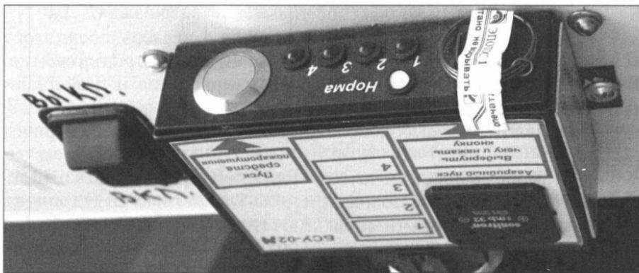
Рис. 26. Щиток и выключатель автоматической системы обнаружения и тушения пожара вагона 71-619КТ.
