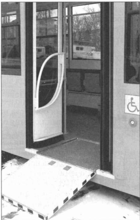
Рис. 76. Откидная аппарель вагона 71-623.
