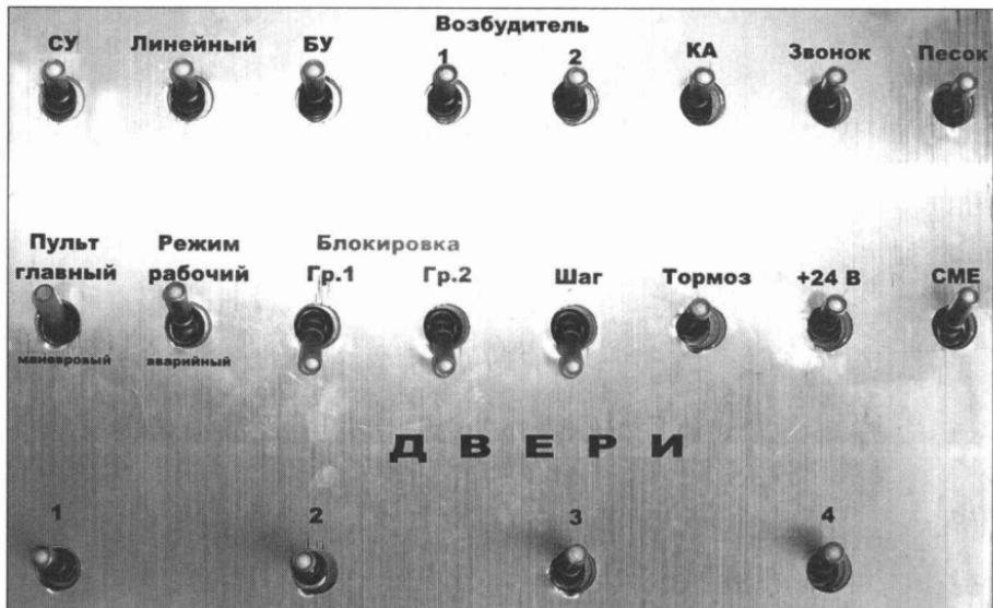
Рис. 23. Панель низковольтных автоматических выключателей и тумблеров вагона 71-619КТ.
