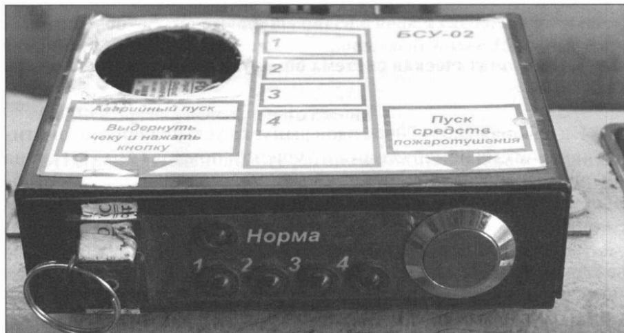
Рис. 60. Щиток и выключатель автоматической системы обнаружения и тушения пожара вагона 71-134А.
