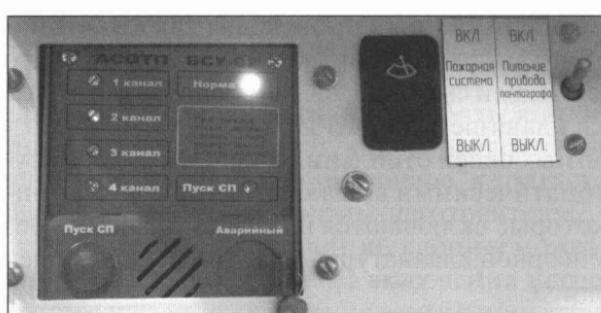
**Рис. 77. Щиток и выключатель автоматической системы обнаружения и тушения пожара вагона 71-623.**
