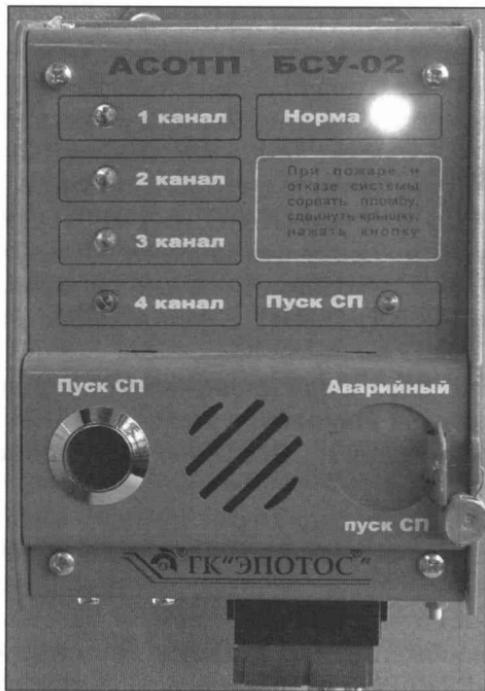
Рис. 71. Щиток автоматической системы обнаружения и тушения пожара (АСОТП) вагона 71-153.
