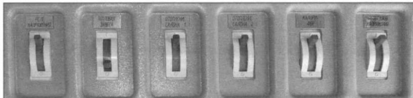
Рис. 66. Панель высоковольтных автоматических выключателей вагона 71-153.
