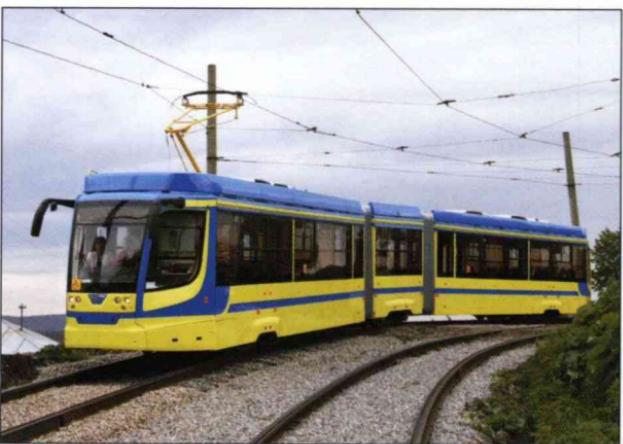
3. Шестиосный трёхсекционный шарниро-сочленённый частично низкопольный вагон 71-631 производства УКВЗ (Усть-Катав).
