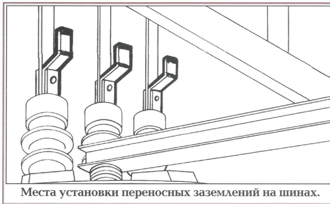
Места установки переносных заземлений на шинах.
