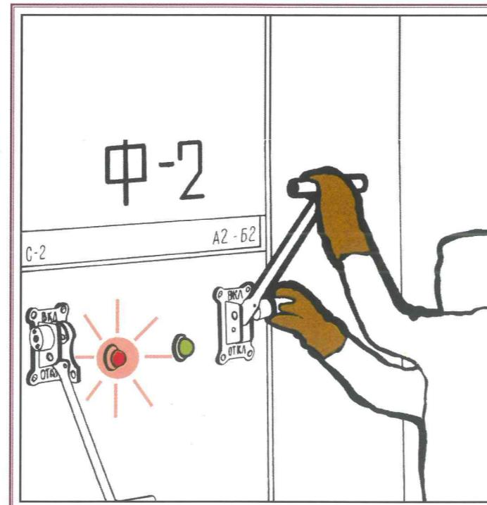
При включенном быстродействующем выключателе блокировка не должна позволить отключить разъединитель.
