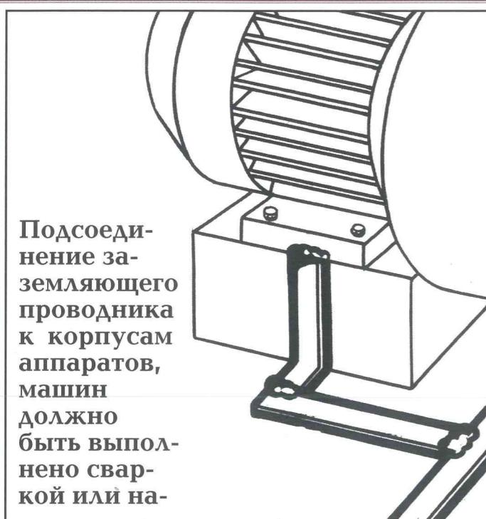
Подсоединение заземляющего проводника к корпусам аппаратов, машин должно быть выполнено сваркой или на-
