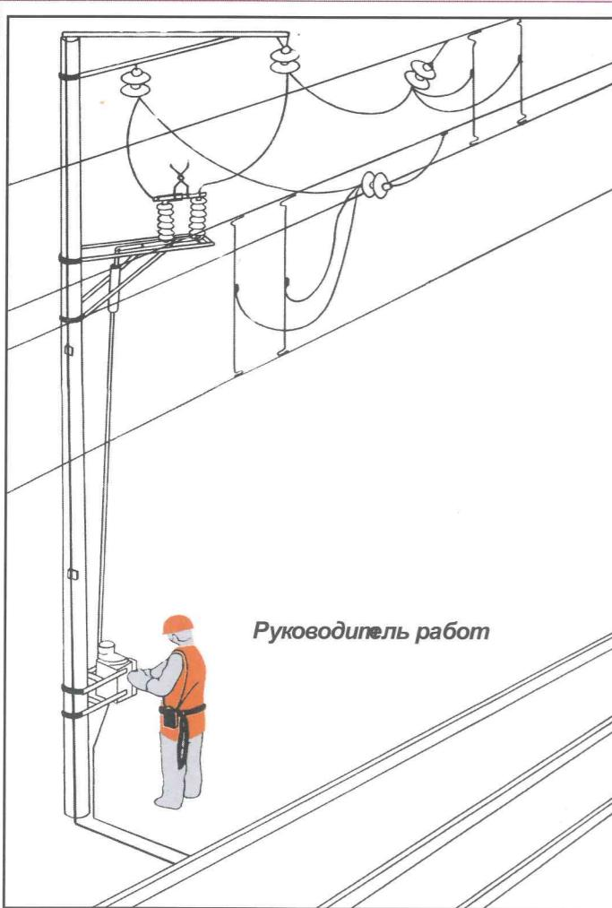
Включи разъединитель, оставь открытой крышку привода.
