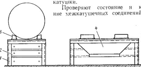
Рис. 132. Берстак для ремонта тягового двигателя:
